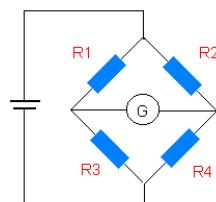
Ce pont sert à mesurer un équilibre ou un déséquilibre électrique. Les principales applications se retrouvent tout naturellement dans la mesure de grandeurs physiques. Un exemple concret est l'impédance d'antenne.
